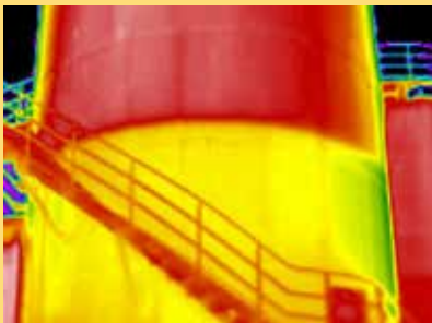
对储罐液位线进行快速二次校验
